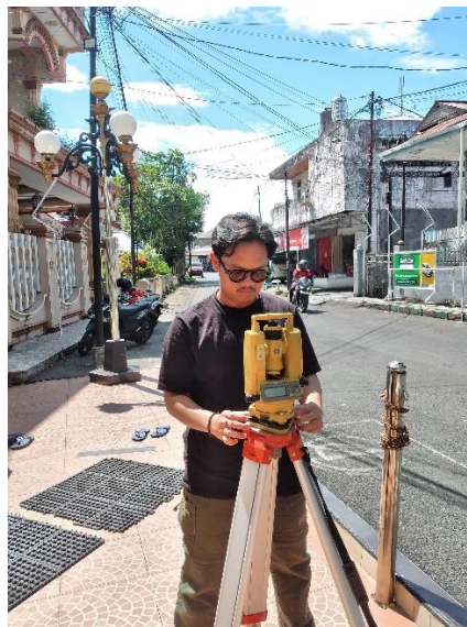
Gambar 4.3 Proses penentuan arah kiblat Masjid Masyhur Istiqlal dengan menggunakan theodolite
